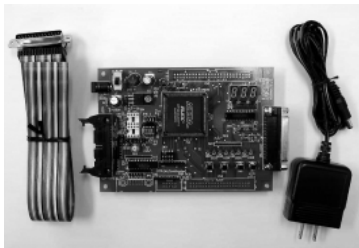
【写真1】FLEX10K10ブレッドボードキット(完成品)
